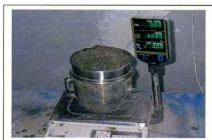
Photo.3. Essai de stabilité au tamis.
